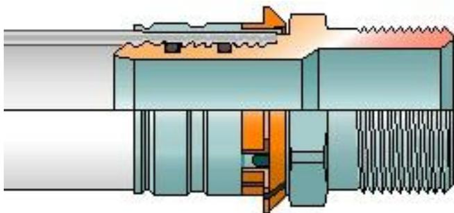
Les raccords à sertir prévus pour les diamètres de 14 mm, 16 mm, 18 mm, 20 mm, 25 mm et 32 mm et les accessoires existant pour cette gamme sont fabriqués à partir de laiton étamé anti-dézincification et font l'objet d'un post-traitement thermique conformément à la NBN EN 12164 et à la NBN EN 12168 (CuZn40Pb2). Les deux bagues d'étanchéité sont fabriquées en EPDM.
