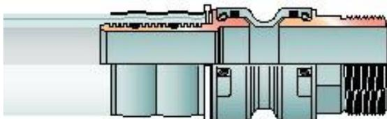
Les raccords à sertir modulaires prévus pour les diamètres de 63 mm, 75 mm, 90 mm et 110 mm et les accessoires existant pour cette gamme sont fabriqués à partir de laiton étamé anti-dézincification et font l'objet d'un post-traitement thermique conformément à la NBN EN 12164 et à la NBN EN 12168 (CuZn40Pb2). Les deux bagues d'étanchéité du raccord à sertir et la bague d'étanchéité du composant de base sont fabriquées en EPDM.
