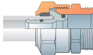
Les raccords à compression prévus pour les diamètres de 14 mm, 16 mm, 18 mm, 20 mm et 25 mm et les accessoires existant pour cette gamme sont fabriqués à partir de laiton étamé anti-dézincification et font l'objet d'un post-traitement thermique conformément à la NBN EN 12164 et à la NBN EN 12168 (CuZn40Pb2). Le manchon de support est fabriqué en PPSU (polyphénylsulfone). La bague de serrage est fabriquée en PA (polyamide). Les deux bagues d'étanchéité sont fabriquées en EPDM.
