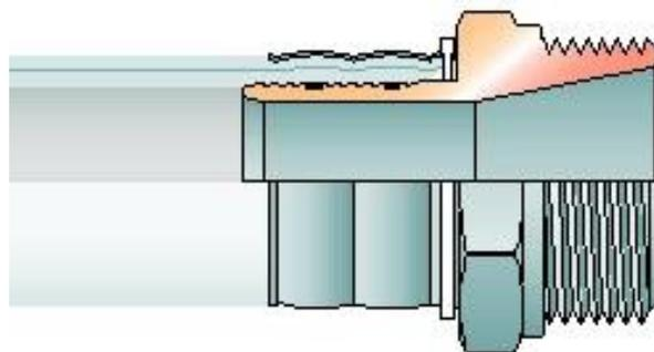
Les raccords à sertir prévus pour les diamètres de 40 mm et 50 mm et les accessoires existant pour cette gamme sont fabriqués à partir de laiton étamé anti-dézincification et font l'objet d'un post-traitement thermique conformément à la NBN EN 12164 et à la NBN EN 12168 (CuZn40Pb2). Les deux bagues d'étanchéité sont fabriquées en EPDM.
