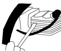
Les ailes du cylindre sont chargées du refroidissement du cylindre grâce à leur contact avec l'air. Les ailes doivent être toujours propres, sans aucun matériau pouvant limiter son contact avec l'air.
