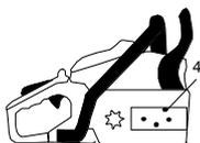
Démonter le guide et vérifiez que l'orifice de lubrification ne soit pas bouché.
