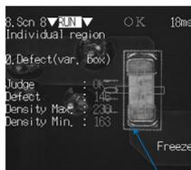
Les zones de détection s'adaptent automatiquement à la taille de la zone.
