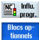
3. Actionnez les touches logicielles "Influ. Progr." et "Blocs optionnels". La fenêtre "Influence sur le programme" s'ouvre avec une liste des niveaux de bloc.
