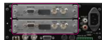
HFBK-HDI/HFBK-SDI Cartes optionnelles installées sur la BRU-H700 (arrière)
