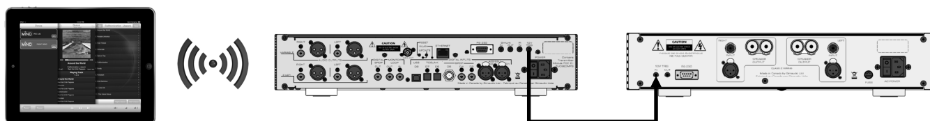
Figure 3: Fonctionnement de la télécommande avec un port de contrôle bidirectionnel
