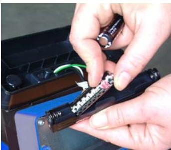
4. Placer les nouvelles batteries sur le support
