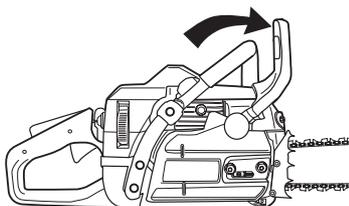
**Allumage; starter:** Mettre la commande de starter sur la position de starter. Le contacteur d'arrêt doit alors se placer automatiquement en position de démarrage.
