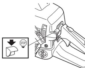
Le moteur est arrêté en poussant l'interrupteur d'arrêt en position d'arrêt.
