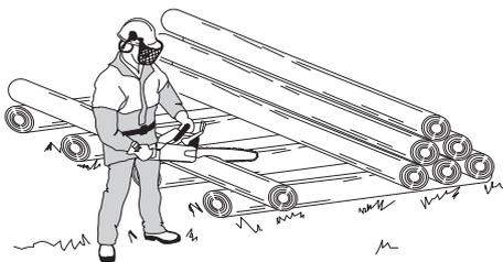
**Le tronc est couché à même le sol.** Il n'y a aucun risque de coincement de la chaîne ou de fendage de la pièce à scier. Par contre, il existe un risque important que la chaîne rencontre le sol après le sciage.
