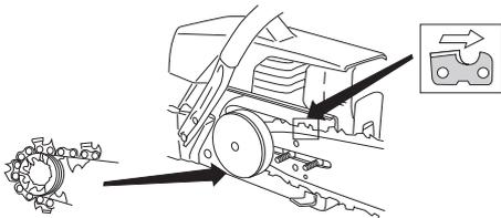
S'assurer que la face tranchante des dents est vers l'avant sur le dessus du guide.
