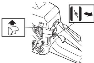
**Ralenti accéléré:** Un ralenti accéléré combiné au starter est obtenu quand la commande est en position de starter.
