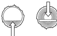
**Les deux extrémités du tronc reposent sur des supports.** Risque important de coincement de la chaîne.
