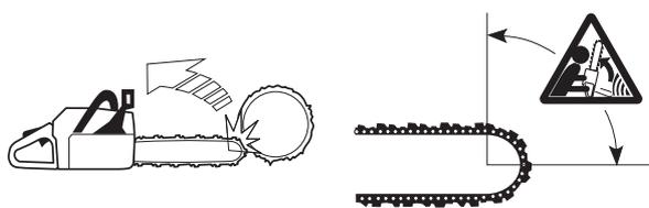
Le rebond se produit toujours dans le plan du guide-chaîne. En général, tronçonneuse et guide-chaîne sont relevés simultanément en direction de l'utilisateur. Néanmoins, la direction du rebond peut varier suivant la position de la tronçonneuse au moment où la zone de rebond du guide-chaîne touche un objet quelconque.
