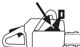
Actionner l'arceau d'avant en arrière pour s'assurer qu'il se meut librement et qu'il est solidement fixé à son articulation dans le carter d'embrayage.
