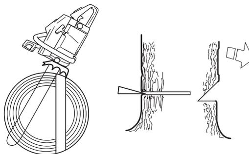
Le trait de chute doit s'achever parallèlement à l'encoche, l'espace entre les deux étant 1/10 du diamètre du tronc. La partie non coupée du tronc s'appelle la charnière.
