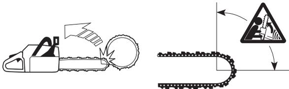
Le tronçonnage avec la partie inférieure de la chaîne, c'est à dire par dessus (de haut en bas), s'appelle méthode "poussée". La tronçonneuse est attirée vers l'arbre et le bord avant de la tronçonneuse devient un appui naturel contre l'arbre. Dans ce cas, l'utilisateur contrôle mieux à la fois sa tronçonneuse et la zone de rebond du nez.
