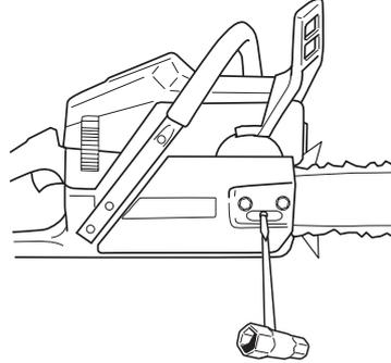
La chaîne est tendue correctement quand elle ne pend plus sous le guide et peut être avancée à la main sans difficulté. Serrer les écrous du guide à l'aide de la clé universelle tout en maintenant levé le pignon du guide.
