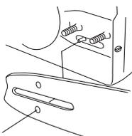
Tendre la chaîne en tournant la vis du tendeur de chaîne vers la droite à l'aide de la clé universelle. Tendre la chaîne jusqu'à ce qu'elle ne pende plus sous le guide. Voir les instructions à la section Tension de la chaîne.
