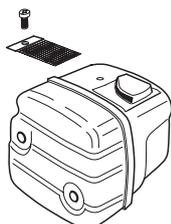
Le silencieux est conçu pour atténuer le bruit et dévier le flux des gaz d'échappement loin de l'utilisateur. Ces gaz sont chauds et peuvent transporter des étincelles risquant de causer un incendie si elles entrent en contact avec un matériau sec et inflammable.
