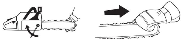
L'emplacement de la vis du tendeur de chaîne varie avec les modèles de tronçonneuses. Voir le chapitre Quels sont les composants? pour savoir où elle se trouve sur votre modèle.
