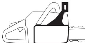
Observer la plus grande prudence en utilisant la tronçonneuse et s'assurer que la zone de rebond du guide-chaîne ne touche rien.
