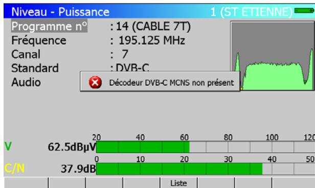
Appui sur une touche de fonction non présente dans l'appareil
