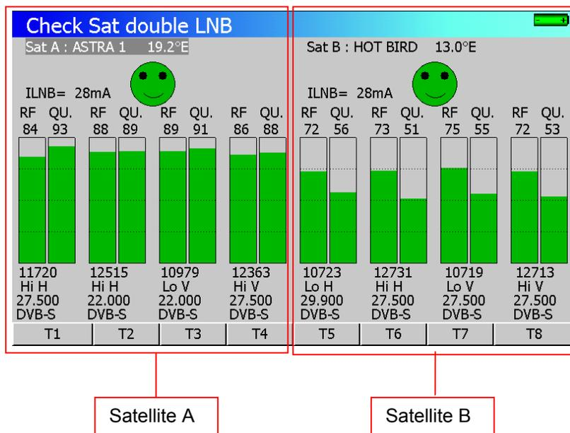
Le satellite A est sur la partie gauche de l'écran et le satellite B est sur la partie droite.
