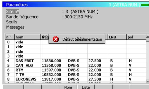
Défaut de la télé alimentation : présence d'une tension sur le câble ou dépassement du courant max.
