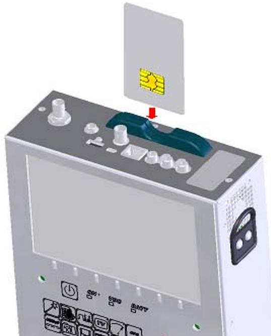
Lorsque la chaîne visualisée en mode TV est cryptée, l'appareil recherche automatiquement sur l'interface carte si une carte d'abonné est présente et si la clé de décryptage est compatible.
