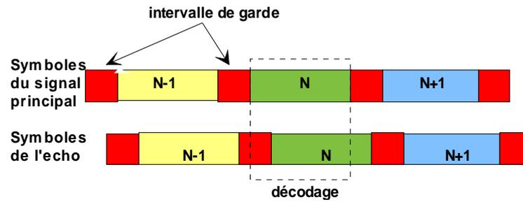
Il faut donc réduire le niveau de réception des echos en orientant l'antenne ou en choisissant une antenne plus directive.
