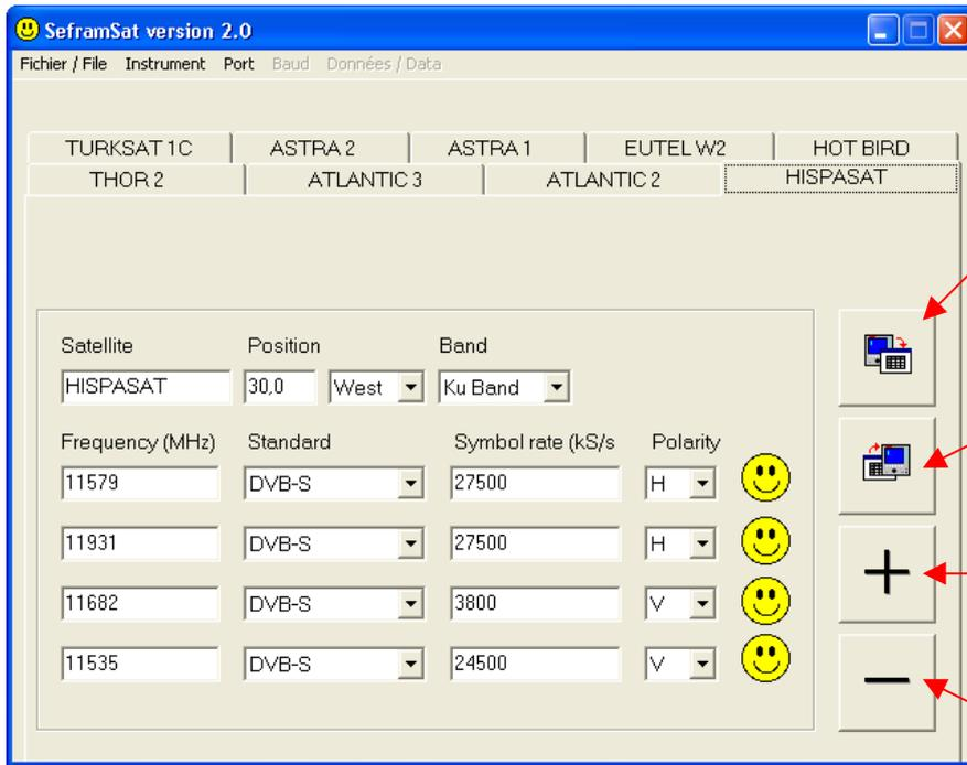
Envoie la liste des satellites contenus dans l'appareil vers le logiciel SeframSat.
