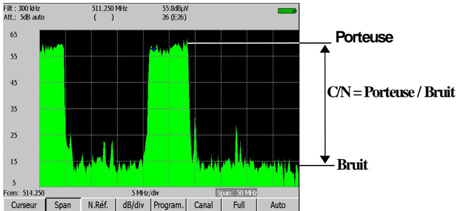
**COFDM** : Coded Orthogonal Frequency Division Multiplex. Codage numérique utilisé pour la TNT. Le principe est de transmettre l'information par une multitude de porteuses (mode 2K ou 8K)
