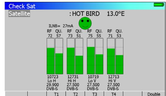
6/ Orienter lentement la parabole jusqu'à entendre la mélodie de verrouillage et obtenir le maximum de qualité
