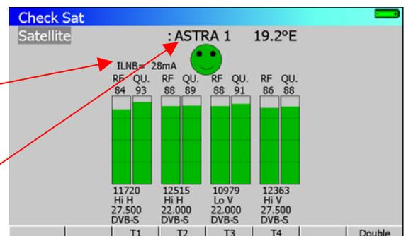
5/ Orienter lentement la parabole jusqu'à obtenir le maximum de niveau et entendre la mélodie de verrouillage.
