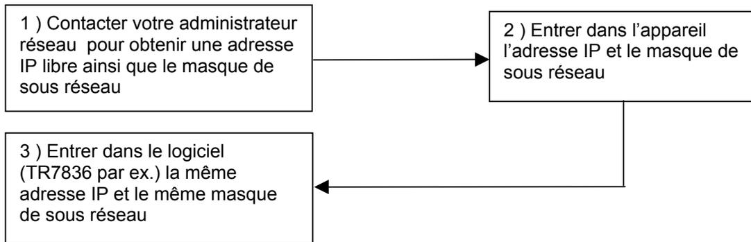
ATTENTION : le raccordement à un réseau informatique peut entraîner des perturbations si le serveur DHCP est activé sur l'appareil.
