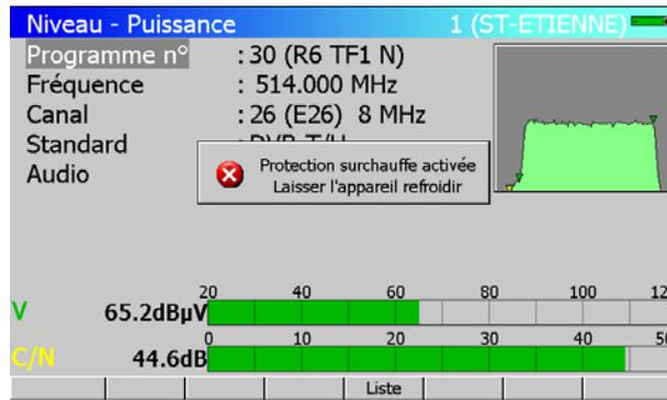
Si la température interne de l'appareil dépasse 60°C : passage en protection.
