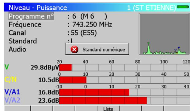
2° appui sur la touche niveau : L'appareil essaie de faire une mesure de taux d'erreur avec un **Standard** différent de **DVB-C, MCNS, DVB-S, DSS, DVB-S2 ou DVB-T/H**.
