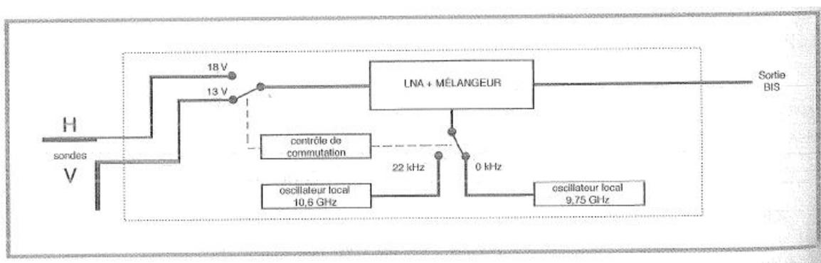
La réception se fait sur 2 bandes de fréquences Basse / Haute et 2 polarisations de l'onde reçue Horizontale / Verticale.
