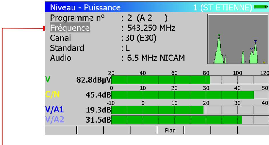
Lorsque la ligne d'un paramètre numérique est pointée (vidéo inverse), la roue sensitive permet de modifier sa valeur.
