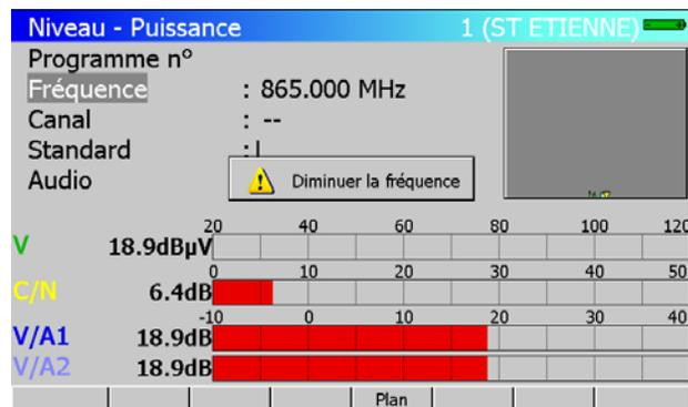
L'appareil essaie de faire une mesure de niveau en dehors de ces possibilités (mesure Audio avec une porteuse vidéo à 865 MHz par exemple)
