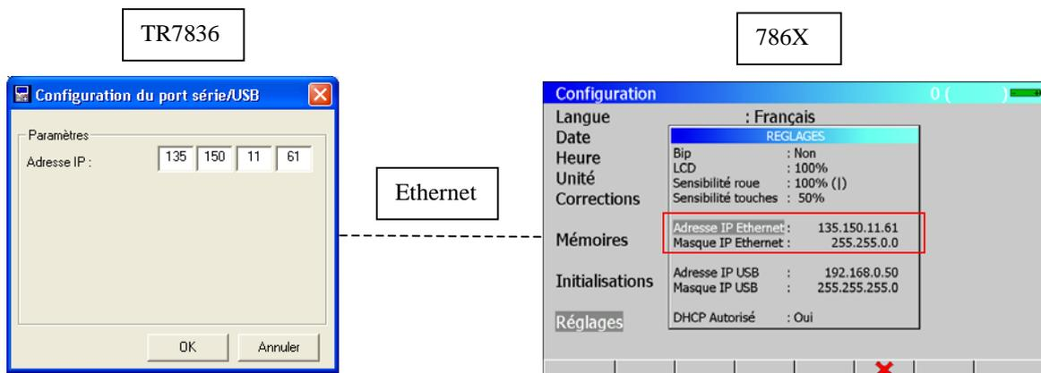
**ATTENTION :** si le PC a déjà été connecté par Ethernet (réseau, modem,...), un redémarrage du PC est indispensable avant de connecter votre appareil.
