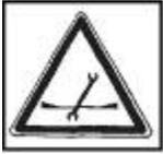
Veiller à ce que la lame ainsi que toutes les pièces en mouvement soient arrêtées avant de nettoyer, réparer ou inspecter la tondeuse
