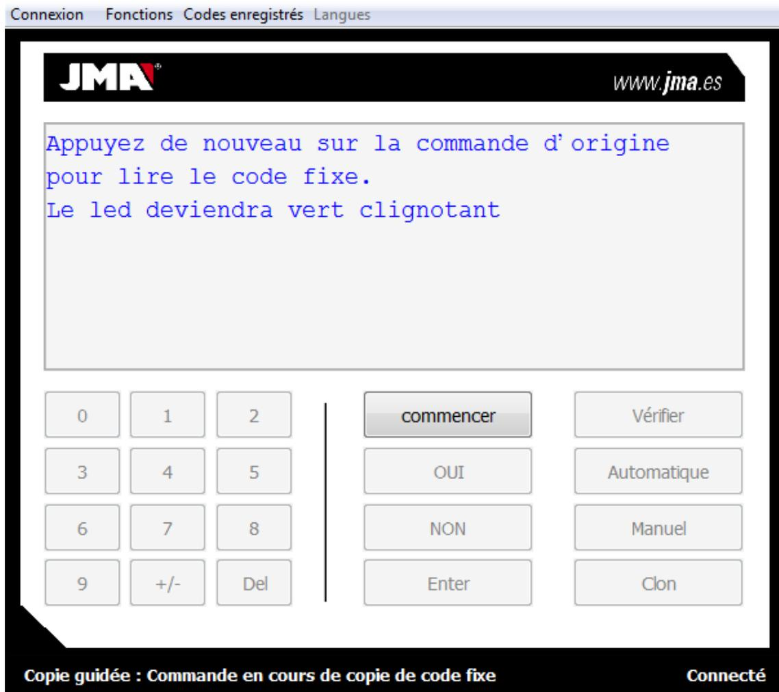
Une fois le code capturé, il faut appuyer sur le bouton 1 si la télécommande originale est une télécommande 433 ou sur le bouton 2 si la télécommande originale est à fréquence variable. Dans ce deuxième cas, il faudra ajuster la fréquence à la fin de l'enregistrement.
