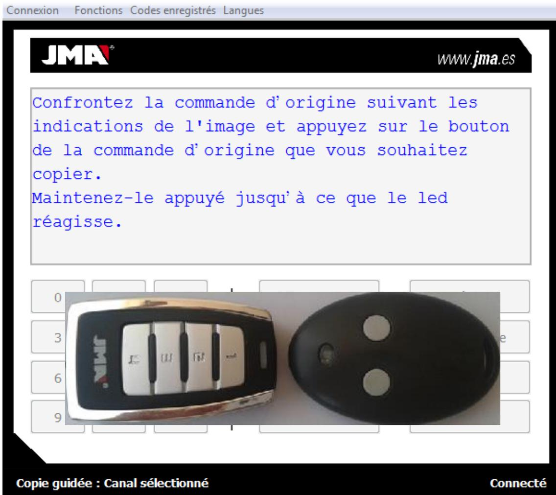
Une fois que la télécommande a capturé le code de l'originale, l'application affiche un message sur l'information reçue. Dans le cas d'une télécommande à Rolling Code, l'application présente l'écran suivant avec la trame reçue.
