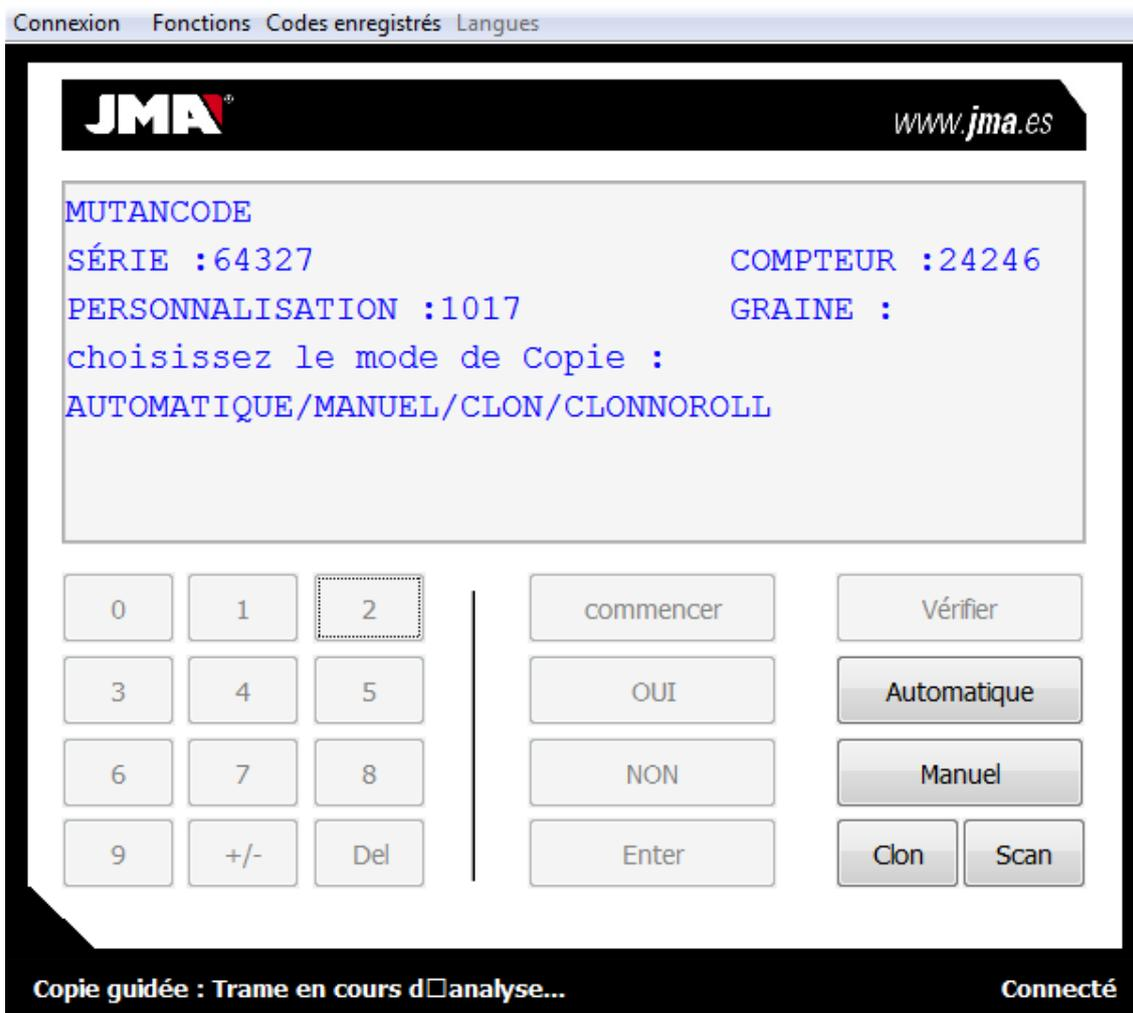
Pour les télécommandes à Rolling Code, il est possible de réaliser la copie en mode Automatique, Manuel, Clon et dans certains cas ClonNoRoll.
