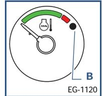
**4 - Voyant de température fluide réfrigérant (B)**
