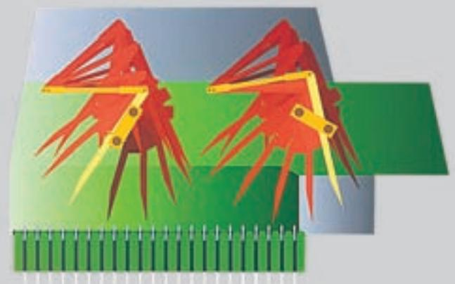
Chaque dent est protégée individuellement par un boulon de cisaillement, pour un flux des plus réguliers.
