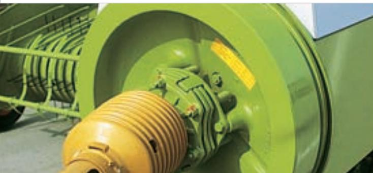
Un grand volant d'inertie placé en amont du boîtier compense les variations de couple provoquées par le mouvement alternatif du piston et évite ainsi tout risque d'endommagement des organes de transmission suite à des surcharges.
