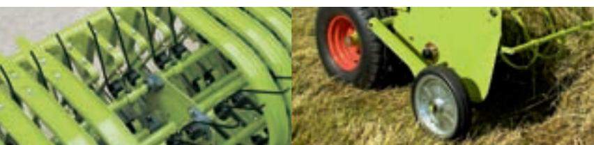
Une roue de jauge réglable en hauteur peut être montée sur le pick-up pour une adaptation parfaite au profil du sol.
