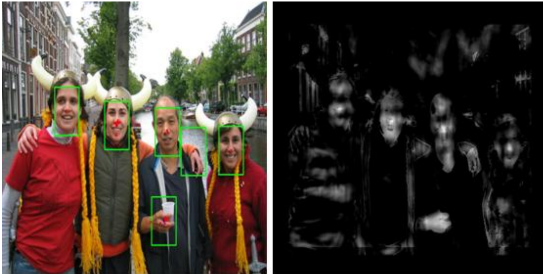
FIG. 3.13 – Photo montrant la détection des faux positifs
