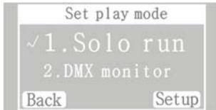
3. Appuyez sur le bouton SET UP. Tournez la molette pour choisir le réglage du mode de lecture : .Solo run, 2.Dmx monitor, 3.Dmx in run ou 4.DmxMidi trigger. Appuyez sur le bouton OK pour valider ou sur le bouton CANCEL pour quitter sans avoir fait aucun changement.
