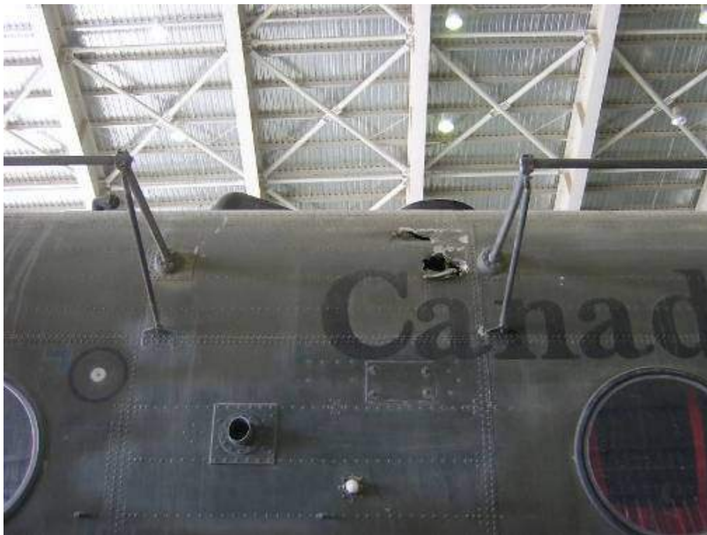
Photo 4 : Dommages causés au côté gauche du fuselage et aux antennes HF.
