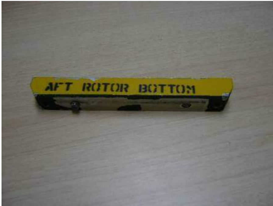
Photo 1 : Butée d'affaissement trouvée sur l'aire de trafic (pale jaune du rotor arrière).
