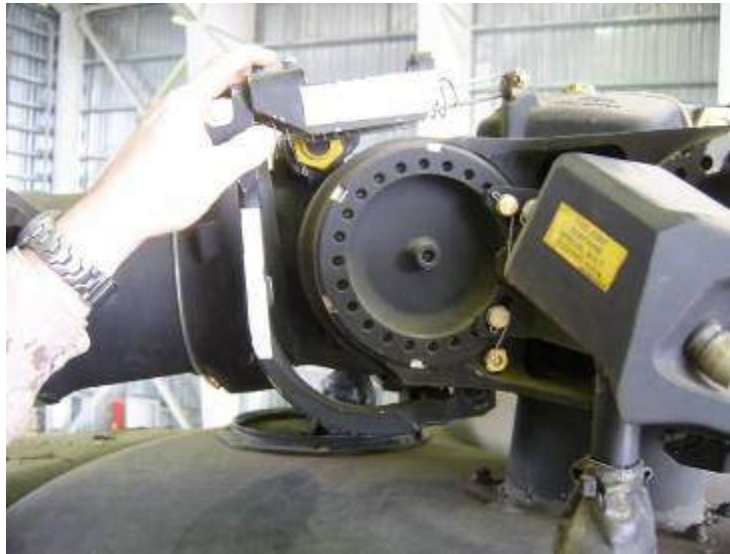
Photo 5 : Butée centrifuge (maintenue en position sortie).
