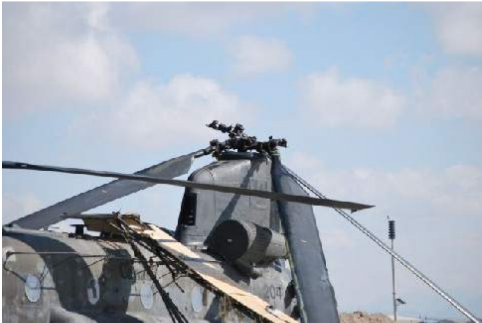
Photo 3 : Dommages causés à la tête du rotor arrière et à la plate-forme (ou l'échelle) adaptée.
