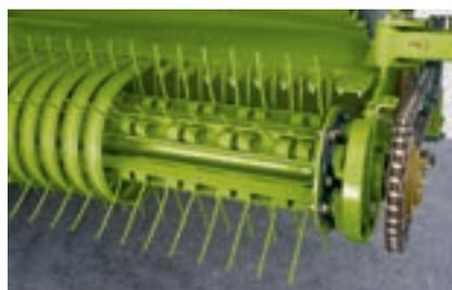
Pick-up robuste pour un ramassage propre du fourrage
