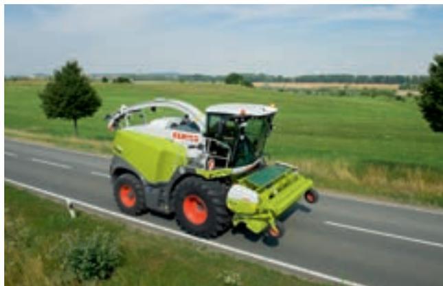
Sur les becs à maïs d'une largeur de travail jusqu'à 6 m, les unités latérales se replient verticalement. Les ORBIS 750 et ORBIS 900 se replient en portefeuille. Pour assurer le respect des charges autorisées par essieu, un système de transport intégré est proposé en option sur les ORBIS 750 et les ORBIS 900.
