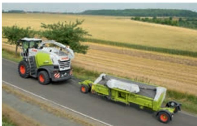
La DIRECT DISC est installée sur le châssis de transport et verrouillée sans outil. Vous pouvez ainsi rouler jusqu'à 25 km/h en toute sécurité.
