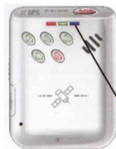
Etape 2 : Après la mise sous tension, la LED GSM s'allume en premier (Elle s'allume 1 seconde et s'éteint pendant 4 secondes pour chercher le réseau GSM, ou 0,05 seconde et s'éteint 4,95 secondes après avoir trouvé le réseau GSM).
