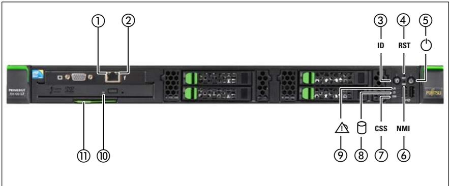
Image n° 6 : Éléments de commande et voyants en face avant
