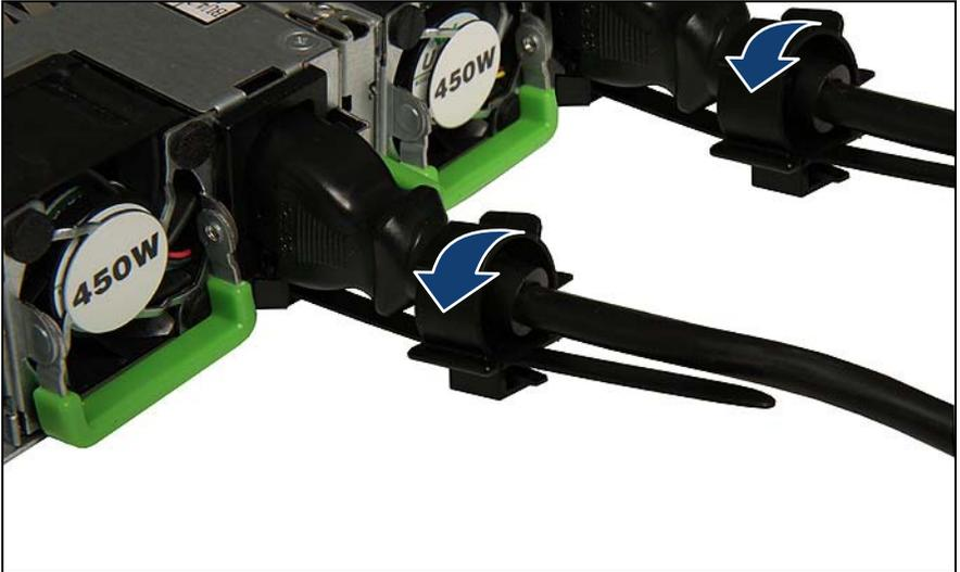
Image n° 5 : Utiliser des décharges de traction de câble
