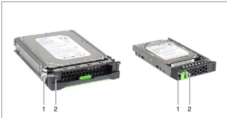
Image n° 7 : Voyants sur le module de disque dur "hot-plug"
