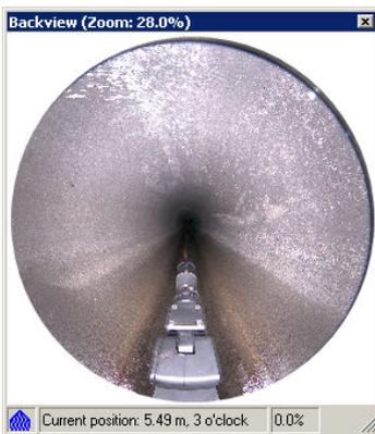
Figure 14 : Étalonnage insuffisant de la vue arrière.
