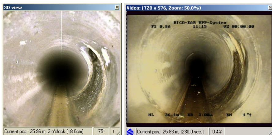
Figure 12 : 2 vues de face du même emplacement réalisées au cours d'un scan Rico RPP : fenêtre de vue 3D (à gauche) et fenêtre de vue de face avec image vidéo.
