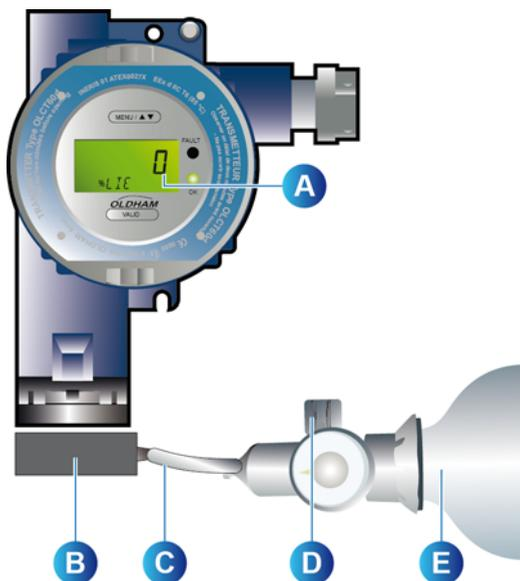
**Figure 27 : contrôle du zéro.**
