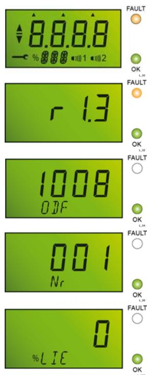
Figure 7 : étapes de l'affichage à la mise sous tension.
