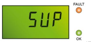
Figure 26 : affichage après détection d'une haute teneur en explosimétrie.
