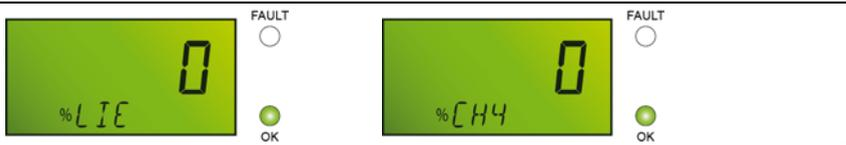
Figure 8 : affichage en fonctionnement normal.
