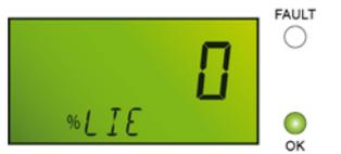
Figure 24 : affichage en fonctionnement normal.
