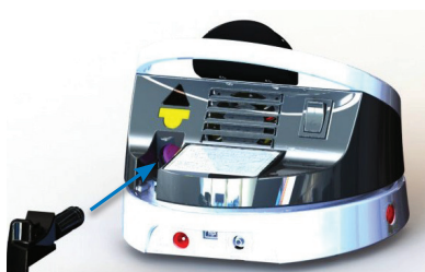
Figure 3.7 : Port d'accès optique / Rainure de rangement de la fibre
