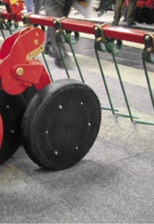
Fig. 1: Par rapport aux socs semeurs conventionnels exerçant une pression autour des 10 kg (à gauche), le guidage de socs à disques avec des pressions élevées (env. 80 kg) implique des roues de jauge complémentaires (à droite). Ils permettent de semer dans un lit de semences grossier comportant des résidus de paille.
