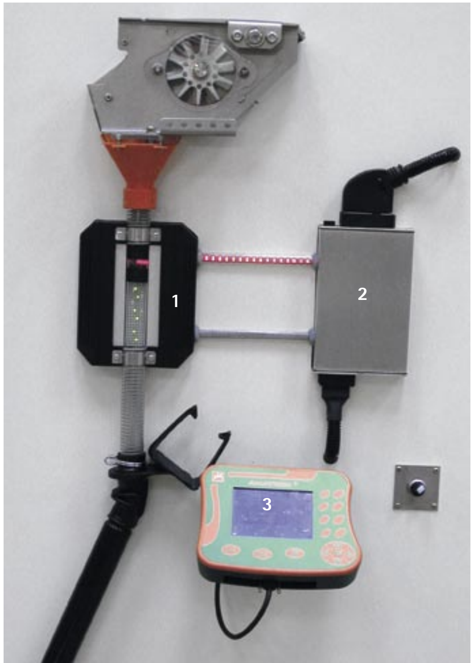
Fig. 5: Le capteur optique (1) intégré dans la conduite de semis, avec ordinateur de bord (2) et terminal ISO-Bus (3) permet l'arrêt automatique de la machine et la régulation spécifique de la densité de semis.
