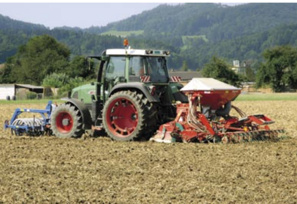
Fig. 2: Les semoirs pneumatiques se manient simplement et le réservoir à grains se vide facilement. La précision de semis n'est cependant pas meilleure que celle des semoirs mécaniques.
