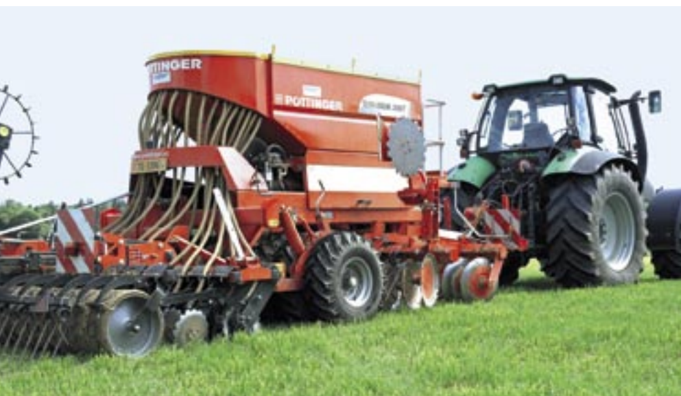
Fig. 6: Les semoirs deviennent de plus en plus complexes, raison pour laquelle l'électronique y prend une part accrue. Pour éviter d'équiper chaque machine d'un terminal de commande, le système ISO-Bus fait sa place sur ces machines également. Il est ainsi possible de commander celle-ci depuis le terminal du tracteur, un pas important vers l'avenir!
