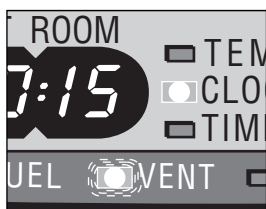
L: Hvis kontrollampen VENT lyser, betyder det, at der skal udluftes i rummet.
