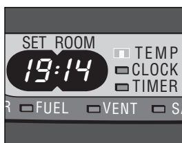
G: Links de gewenste temperatuur, rechts de gemeten temperatuur.
