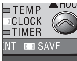
J: Når lampen SAVE lyser, slukkes eller tændes kaminen automatisk, sådan at temperaturen holder sig inden for et bestemt temperaturområde.
