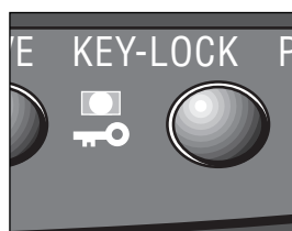
I: Når lampen KEY-LOCK begynder at lyse, er børnesikringen aktiveret.
