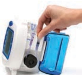
5. Tenir la bague noire, et étendre doucement le tube de silicone pour l'enrouler autour du rotor dans le sens antihoraire. Tracter la bague noire pour la placer dans l'emplacement à droite.
