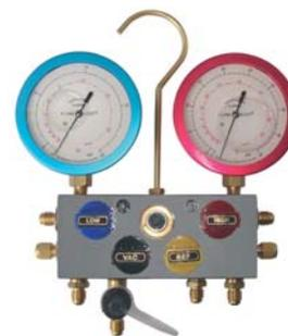
JEU DE MANIFOLD en mallette de transport, inclus 3 flexibles de 150 cm avec joints Téflon
