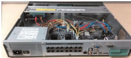
4. Retirez les vis de support du disque dur (4x) et soulevez-le pour le sortir du système.
