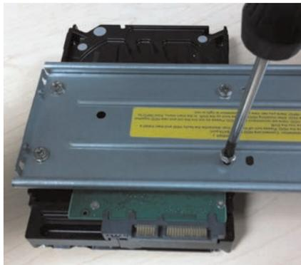
6. Remplacez le support du disque dur et ses vis (4x). Remplacez le couvercle et les vis du couvercle (2x).
