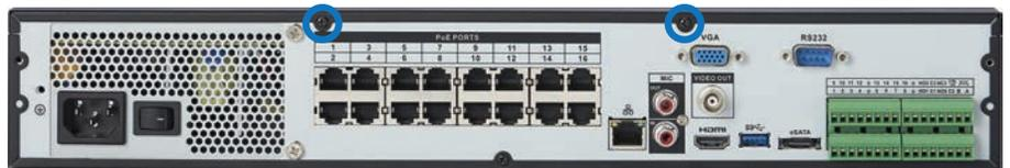
3. Retirez les vis de support du disque dur (4x) et soulevez-le pour le sortir du système.
