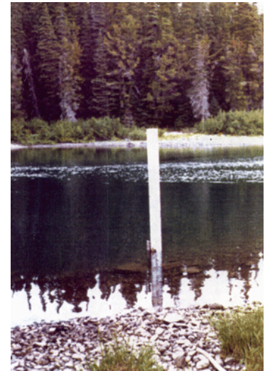
Figure 4. Échelle limnimétrique verticale fixée à un fer-cornière
