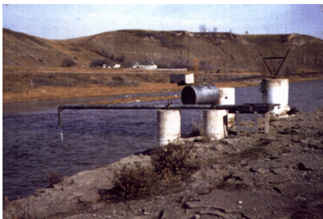
Figure 14. Limnimètre en porte-à-faux fixe installé horizontalement
