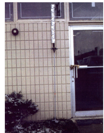
Figure 2. Échelle limnimétrique verticale fixée à une ancre à tige filetée
