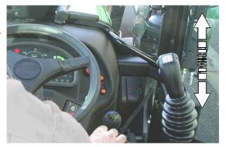
**14.2.2** Commande de la ligne hydraulique auxiliaire (suivant équipement). Actionner le manipulateur MX vers la droite et la gauche.
