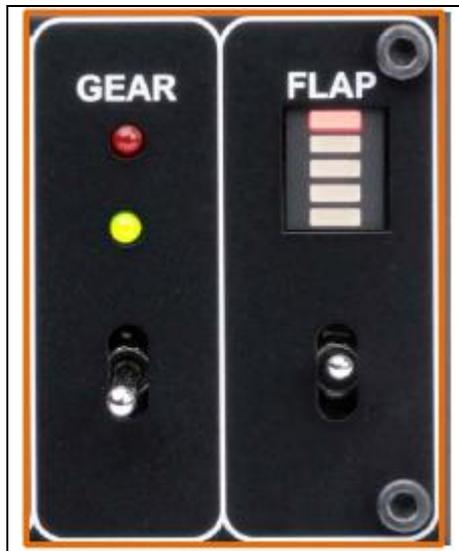
Levier à bascule HAUT/BAS : contrôle le train et les volets.
