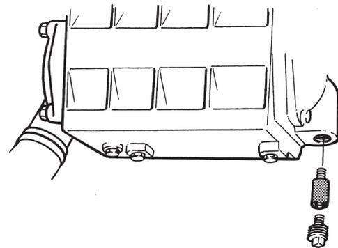
Anode en zinc dans le couvercle avant de l'échangeur de température sur les TAMD63.
