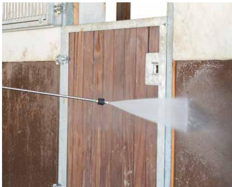
Fig. Lance avec buse réglable
