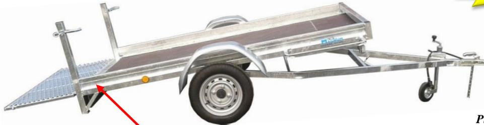
Hayon arrière amovible de 0,60m pour monter un véhicule
