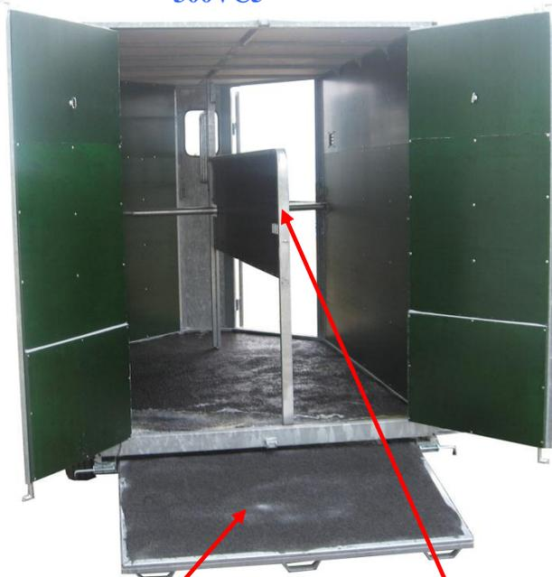
Pont sous châssis en résine antidérapante sur plancher bois
