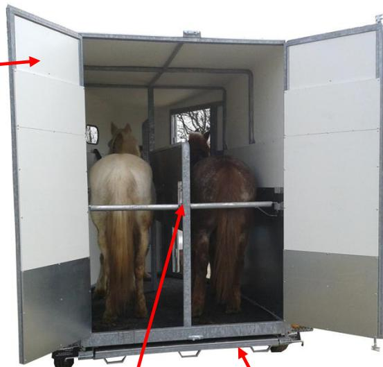
Séparation intérieure démontable avec barre anti-recul
