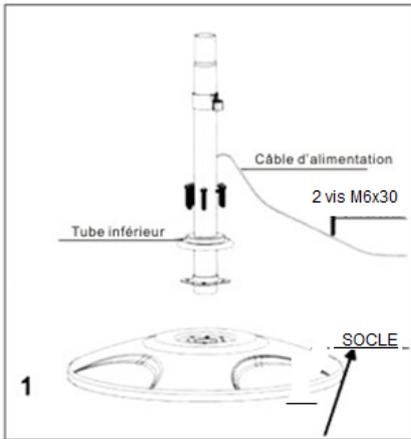
Insérer le tube inférieur (11) dans le socle (15) et le fixer avec 4 vis M6 X 30 (fig.1).
