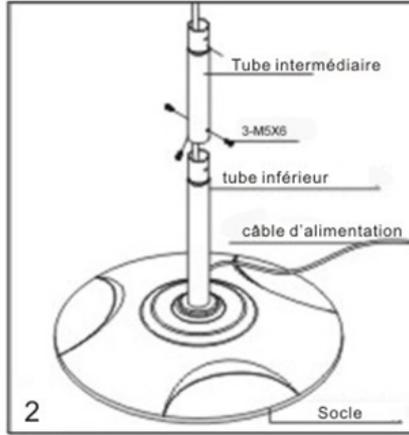
Assembler le tube inférieur (11) et le tube intermédiaire (9) en utilisant 2 vis M5 X 6 fig.2).
