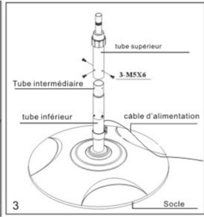
Assembler le tube supérieur (7) et le tube intermédiaire (9) en utilisant 2 vis M5 X 6 fig.2).
