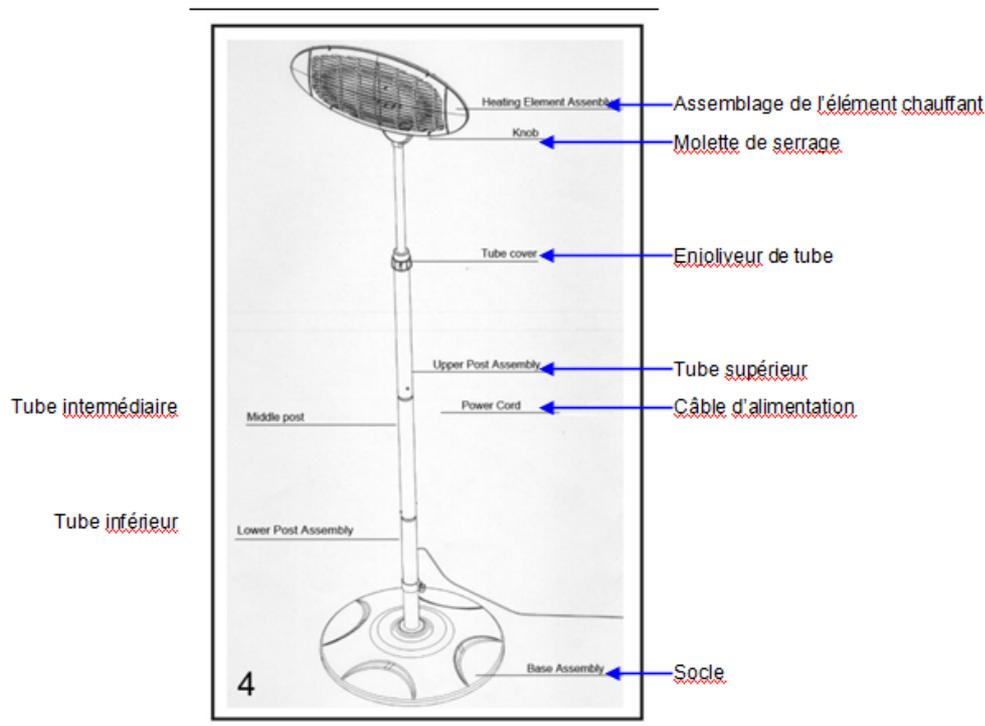
Fixer l'élément chauffant (1) au tube supérieur (7) l'immobiliser en serrant la molette (fig.4)
