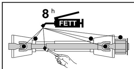
En cas d'utilisation en hiver graisser les tubes protecteurs pour éviter qu'ils ne se bloquent ensemble par le gel.
