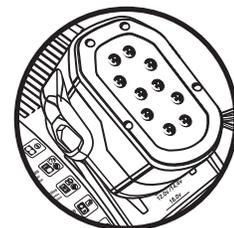
**Remarque :** Les blocs de batteries 9,6 V, 12 V et 14,4 V ne s'insèrent pas à fond dans la prise du chargeur. Ces blocs de batteries doivent être insérés de manière à ce qu'ils s'encliquettent et soient alignés sur la ligne du chargeur représentée à gauche.
