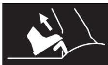
**ATTENTION** Le relâchement de la pédale doit toujours être graduel pour éviter qu'un enclenchement trop brusque de la traction puisse causer le cabrage et la perte de contrôle de l'appareil, surtout sur les pentes.
