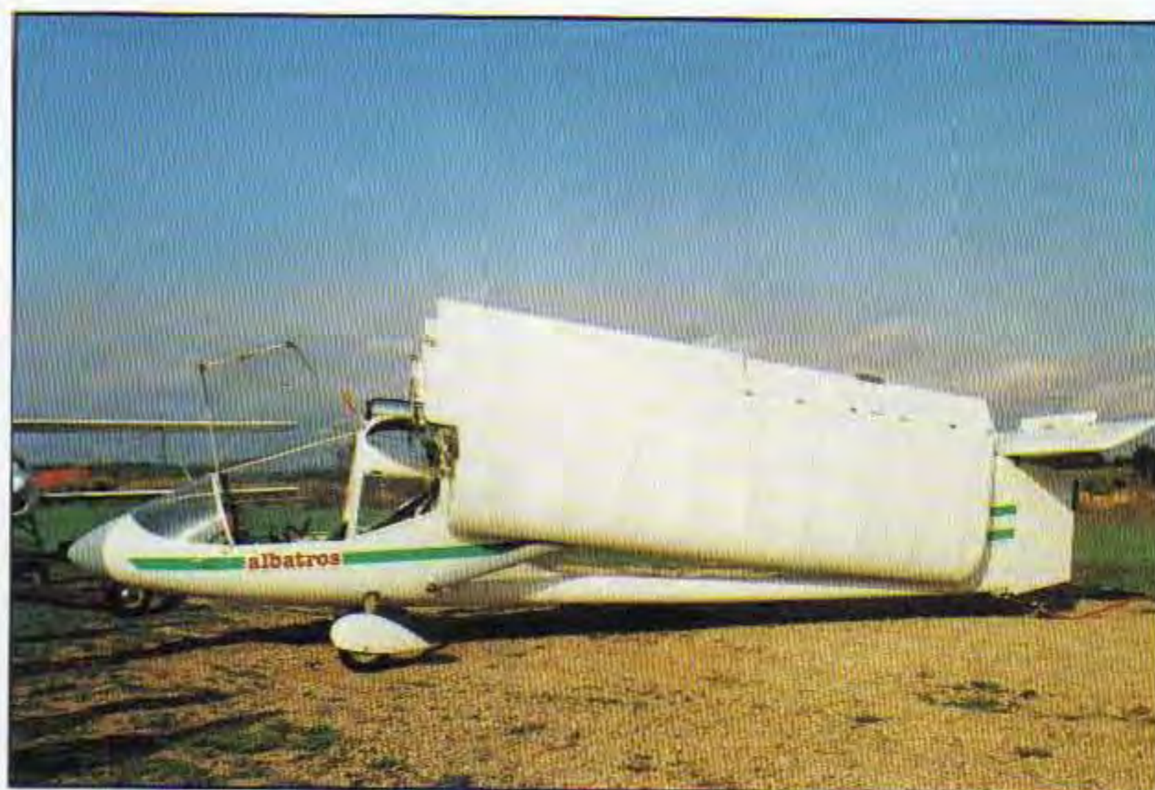
articulations des haubans (version Rotax 582) - une minute plus tard, c'est terminé. Voici une vue de côté de l'Albatros une fois replié.
