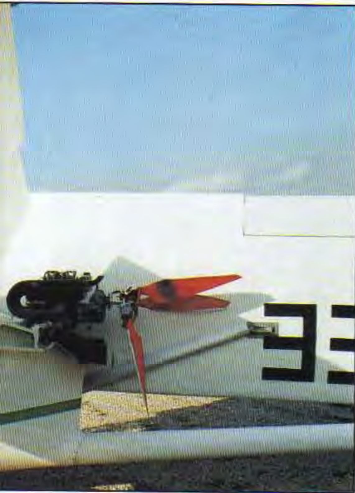
articulations des haubans (version Rotax 582) - une minute plus tard, c'est terminé. Voici une vue de côté de l'Albatros une fois replié.
