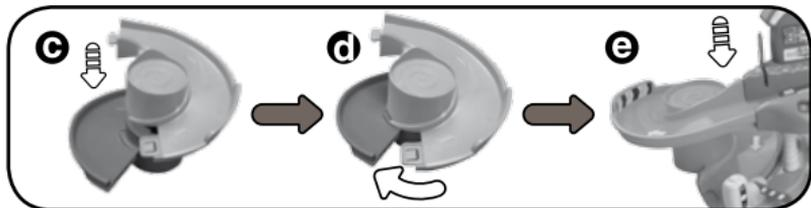
5. Insérer le support dans la fente située sous le plateau pivotant.
