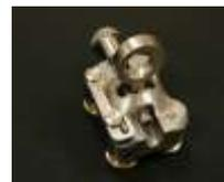
**CHARIOT HST 1 :** Chariot composé d'un corps, d'un plat plié ou non, avec 1 axe, et de 4 roulettes avec 4 axes. Toutes les pièces sont en acier inoxydable et taillées dans la masse. Le plat plié est muni d'un trou pour introduire le mousqueton qui le lie à l'opérateur. Le glissement du chariot sur le rail est aisé. En cas de chute, le chariot bloque immédiatement. Ce chariot est utilisé lorsque le rail-T est placé au sol, à côté ou au-dessus de l'opérateur. (Voir feuillet disposition)
