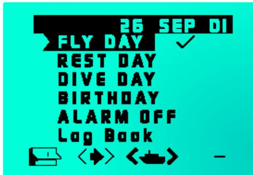
Pour définir une alarme, mettez en contraste le paramètre ALARM OFF, utiliser +/- pour ajuster l'heure d'alarme. Pressez (→) pour passer des heures aux minutes. Quand l'heure de l'alarme (Date/Heure) est atteinte, l'appareil se mettra en route automatiquement.
