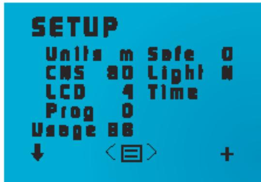
Activez ↓ pour déplacer le curseur. Activez + augmente la valeur ou pour changer le paramètre. Par exemple, quand Units /Unité est sélectionné, on peut passer de m (mètre) à Ft ( Feet/ pieds). En sélectionnant Time – horloge, le menu pour la mise à l’heure apparaît (voir page 13). La sélection de ☰ vous ramène dans le menu d’option.
