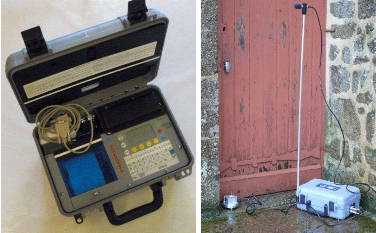
Détails de la chaîne de mesure SUPERGRAPH et de son embase réglable à sceller
