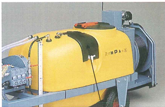
réservoir d'eau propre
