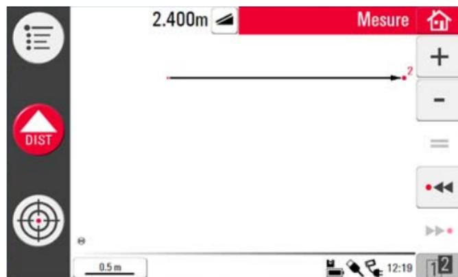
6. Une fois le troisième point mesuré, une "ligne de fermeture" s'affiche entre le premier et le dernier point mesuré. La ligne sélectionnée est toujours mise en surbrillance avec une ligne en gras et une flèche dans la direction de la mesure.
