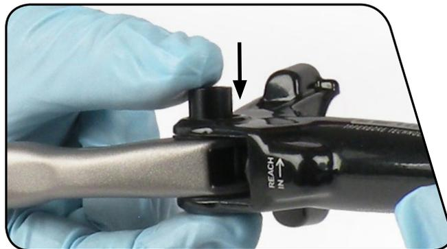
**16** Faites passer le boulon du levier à travers le trou de l'axe d'articulation.
