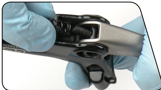
**18** Placez le côté plat de la molette de réglage de la garde sur le ressort, comprimez le ressort et faites glisser la molette de réglage de la garde pour l'installer à sa place dans le corps du levier tout en relâchant doucement le levier.
