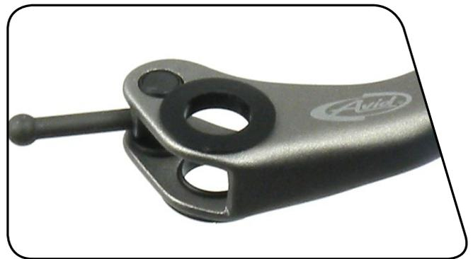
**14** Remettez le levier en place et la tige poussoir de réglage de la garde dans le corps du levier. Alignez l'extrémité arrondie de la tige poussoir avec la cavité du piston. Placez le levier dans le corps du levier afin de faire entrer la tige poussoir dans le piston. Un « clic » se fait entendre lorsque la tige poussoir est bien en place.
