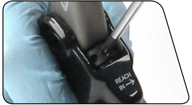
**22** Vissez l'écrou de compression dans le corps du levier à la main. À l'aide d'une clé dynamométrique munie d'une douille articulée de 8 mm pour écrou conique, serrez l'écrou de compression à un couple compris entre 4,9 et 5,4 N·m. Recouvrez l'écrou de compression avec le soufflet de la durite.
