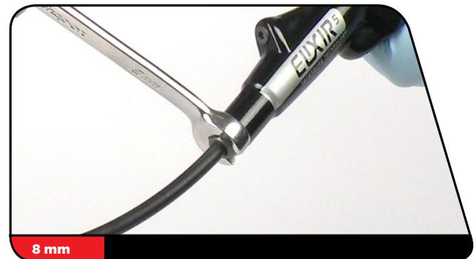
**3** Laissez s'écouler le liquide de frein dans un récipient. Placez le bloc-levier au-dessus du récipient et appuyez sur le levier pour vidanger tout le liquide de frein contenu dans le bloc-levier.
