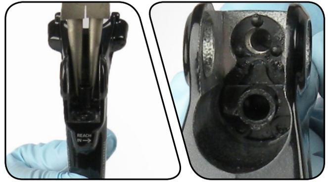
**13** Insérez une bague pivot de chaque côté du levier.
