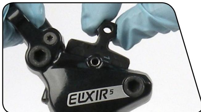
**4** À l'aide d'une clé plate de 8 mm, dévissez l'olive de compression. Tirez sur la durite et sur l'olive de compression pour les détacher du corps de l'étrier.
