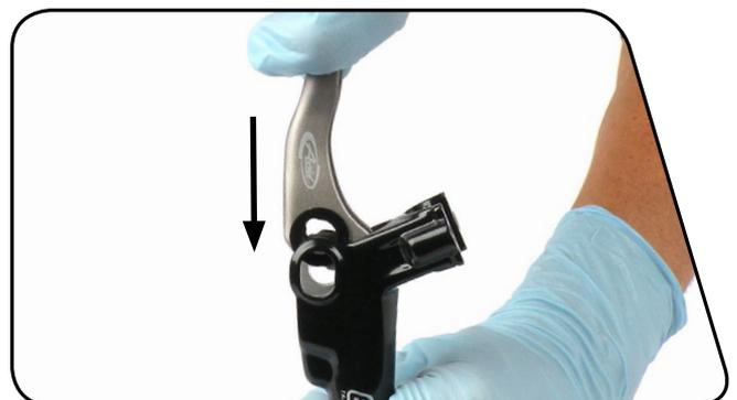
**15** Alignez les trous du levier, des bagues et du corps du levier, puis avec vos doigts, mettez en place l'axe d'articulation.
