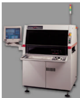
Figure 24 : Système AOI de MVP (AutoInspector 1820)
