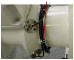
☐ Dévissez et retirez précautionneusement la sonde de son emplacement en utilisant l'outil Faure Herman réf. 204524ENC.
