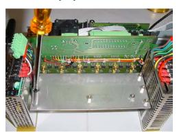
☐ Déconnectez précautionneusement l'ensemble des 12 câbles de sonde.
