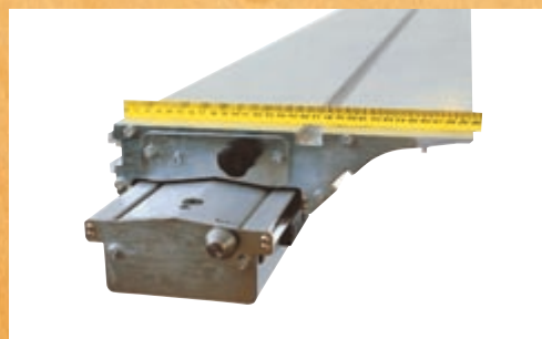
Chariot type F5 Billes et pistes en acier sur banc acier double tunnel. Butée de déglignage. Presse excentrique à 2 patins. Longueur 2000 ou 2500 mm : TS 25 RLX
