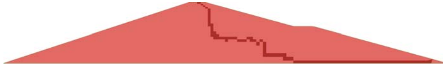
Figure 6. Surface de rupture recherchée « OP ».
