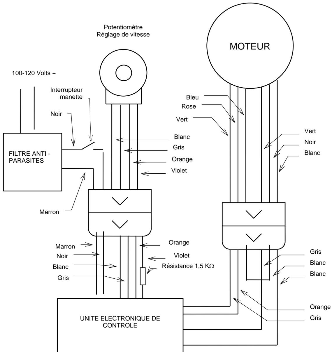
**Schéma électrique 220-240V 50/60Hz**
